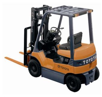
Грузоподъемность 3000 кг 500 мм Центр тяжести груза Вес погрузчика 3800 кг Колеса Суперэластик 1 650 мм Колесная база Высота подъема вил 3000 мм 6/11 град Наклон мачты 1070 мм Длина вил Ширина погрузчика 1240 MM Высота по ограждению 2195 мм Максимальная скорость 15 км/ч Двигатель хода 11,9 кВт Двигатель подъема 14,4 кВт
